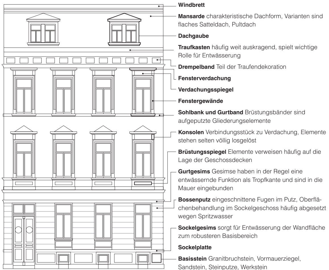
Fassadenelemente eines typischen Gründerzeitgebäudes
